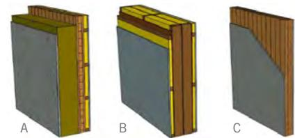
A) Exterior wall B) Separation wall
